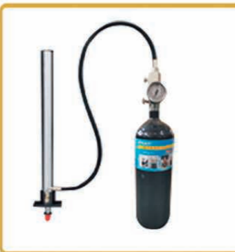
Contra Peso Pneumático com Nitrogênio no eixo Z (VMC série)
