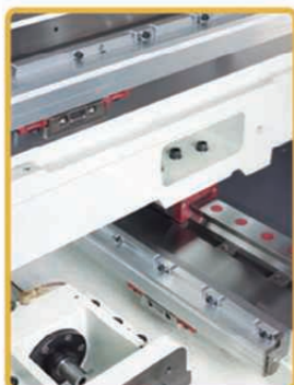
Régua Lineares HEIDENHAIN nos Eixos X, Y e Z
