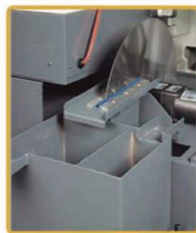
Sistema Separador de Óleo (SKIMMER)
